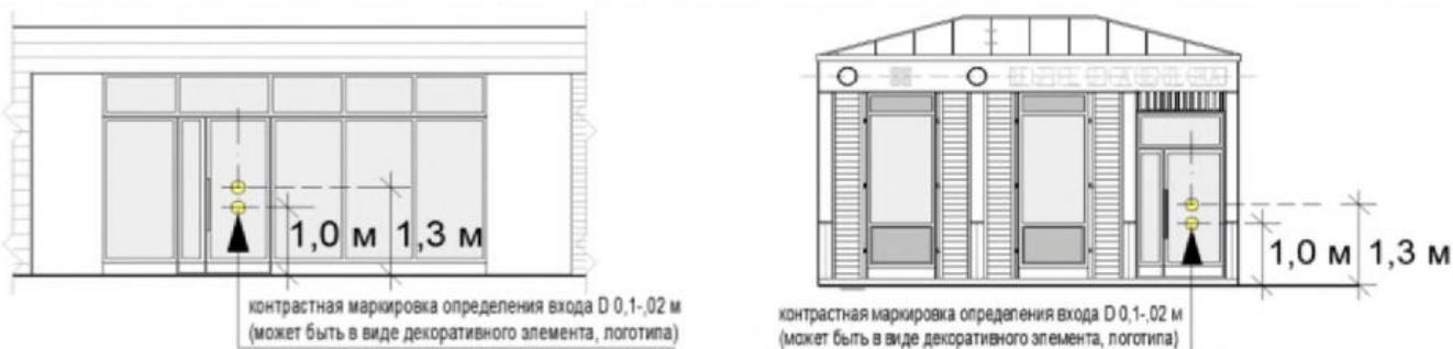
Рис. "Внешний вид контрастной маркировки входа"
